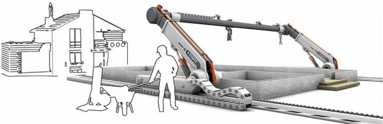
شكل (١٣٤) فى عملية البناء 3d printer شكل يوضح إستخدام تقنية ال
